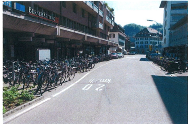
A noter le rétrécissement de chaussée et le marquage de la vitesse au sol
